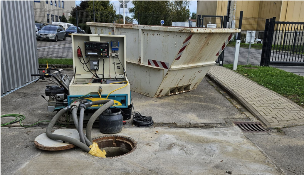
Foto 1: Durchführung des Geothermal Response Test
